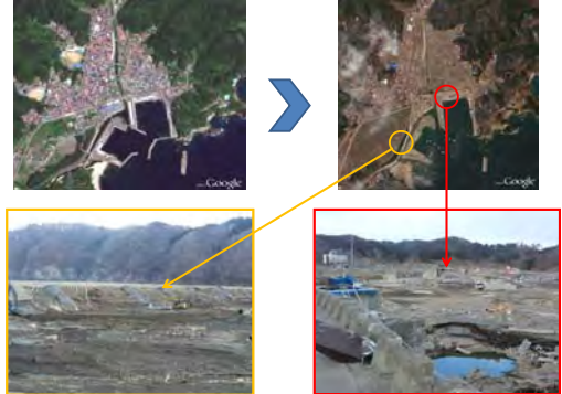
破壊された田老防潮堤：物的被害の軽減はできなかった
